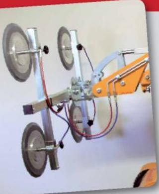
Le système de vide est divisé en deux circuits pour une sécurité maximale. Les circuits de vide sont visibles ici en bleu et en rouge.
