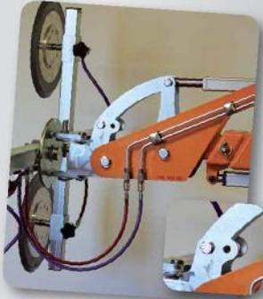
La tête de levage présente deux réglages possibles, avec deux trous pour le boulon de verrouillage. La tête de levage peut ainsi être réglée pour s'incliner plus vers le plafond ou vers le sol.
