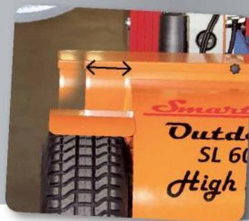
*Cet engin peut se décaler latéralement de 100 mm pour effectuer des réglages précis lors de l'installation des fenêtres.*
