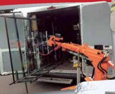
Ce chariot Smartlift peut se décaler latéralement pour effectuer des réglages précis lors des travaux d'installation.
