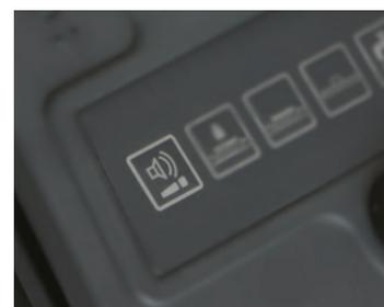
**Réduction du niveau sonore :** Silent-Kit (kit silence) servant à réduire le régime du moteur pour abaisser encore le niveau sonore de la machine (Scrubmaster B90 CL).
