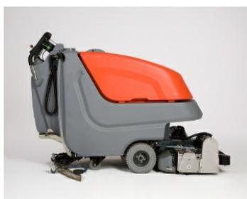
**Ergonomie parfaite :** tableau de commande réglable en hauteur pour une excellente visibilité vers l'avant et une conduite confortable.
