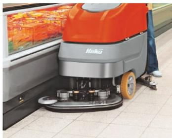
**Passage aisé sous des étagères** grâce au système de brosses ultra plates d'une hauteur de 10 cm seulement. Accrochage et décrochage automatique des brosses.
