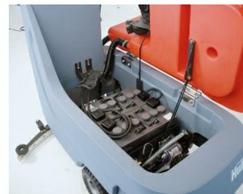
**Maintenance aisée** grâce au remplacement des brosses sans outils, réservoir d'eaux usées facile à nettoyer grâce au couvercle grand format, vidange du réservoir d'eaux usées réglable, affichage d'incidents sur écran et accès facile à la batterie.
