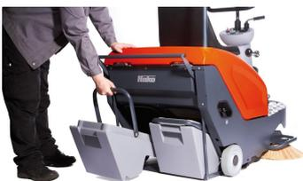
**Particulièrement facile d'utilisation** : système de ramassage des déchets « Take it easy » de la balayeuse Sweepmaster B800 R facilite le vidage des deux bacs à déchets ou le ramassage de déchets plus gros. Les deux bacs permettent également de répartir le poids au mieux.
