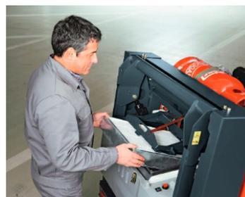
**Air propre et grande autonomie** : système de filtre à cartouche avec grande surface de séparation et technologie de nettoyage de filtre brevetée R<sup>2</sup>S.
