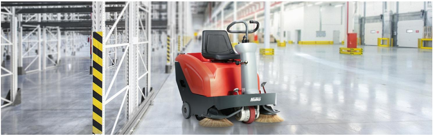
La performance redéfinie : la balayeuse Sweepmaster B800 R allie le petit gabarit d'une balayeuse autotractée confortable au potentiel de puissance d'une machine autoportée. Elle permet de balayer les petites et moyennes surfaces de manière économique sans propagation de poussière avec un rendement de surface jusqu'à 6 650 m<sup>2</sup>/h. .
