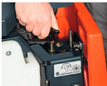
**Compensation de l'usure en toute simplicité** : grâce au système ABBA, le rouleau de balayage principal peut être réglé (en hauteur) de sorte à garantir un balayage toujours parfait sur toute sa durée de vie.
