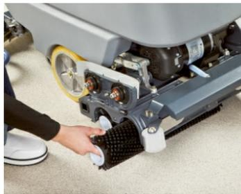
**Version à brosse cylindrique ou brosse à plat** : la machine peut être équipée de différents systèmes de brosses selon les salissures à éliminer. Un tamis à déchets intégré dans le bac permet de collecter les saletés les plus grosses. Les brosses peuvent être remplacés rapidement sans aucun outil.
