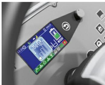
**Écran éclairé et conduite intuitive** : affichage de l'état de charge de la batterie et du niveau de remplissage des réservoirs d'eau propre et d'eaux usées.
