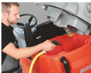
**Nettoyage facile du réservoir** et élimination totale des résidus grâce aux surfaces de réservoir intégralement lisses. Entretien simplifié : signalisation en jaune de tous les points à contrôler et à entretenir.
